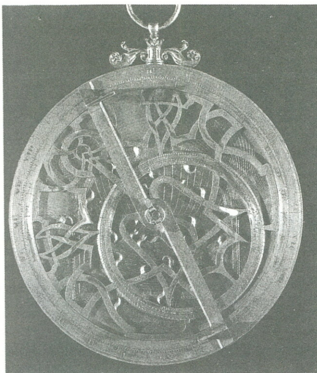
Astrolabio (csillagszögmérő). Az araboktól lesték el a spanyol hajósok, segítségével a bolygók állásából közelítőleg meg tudták határozni helyüket az óceánon
