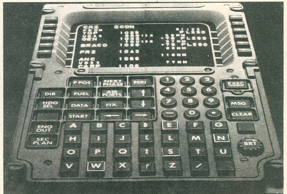
Az A-310-es repülésvezérlő digitális számítógépének kezelő- és kijelzőegysége
