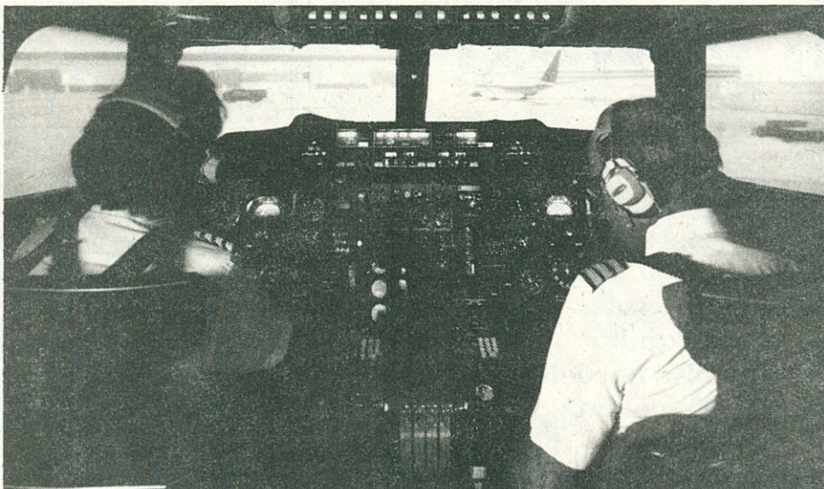
A Rediffusion cég Concorde szimulátora (a repülés valamennyi fázisa gyakorolható vele) – „Full flight simulator”
