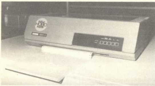
Az Izot 6311C típusú margaréta-kerekes mikronyomtató
