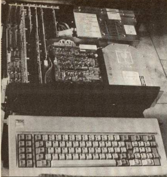
Az IBM PC XT modell belőről. Bal oldalon látható az alapkártya vége és néhány behelyezett bővítőkártya. Középen helyezkedik el a floppy meghajtó, jobb szélén a Winchester lemez egység, hátul pedig a tápegység.
